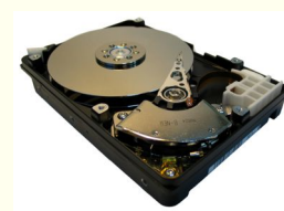
5.3. ábra: Egy merevlemez belseje A sajátodat ne akard így látni, mert az azt jelenti, hogy tönkrement!
