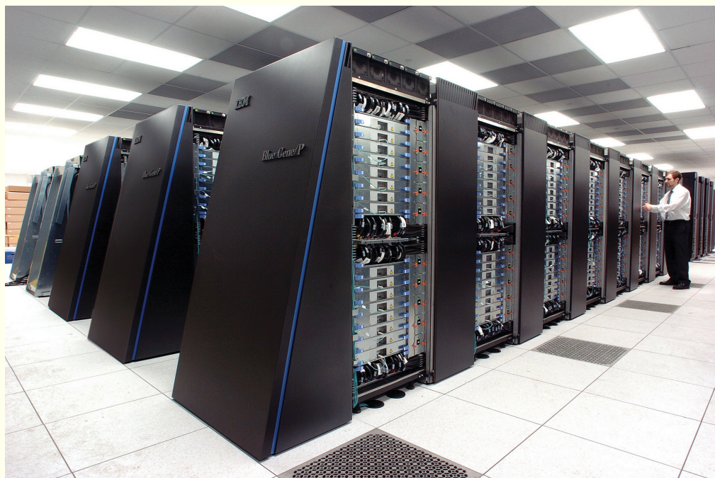
Az IBM Blue Gene/P szuperszámítógépe, az „Intrepid” mely az Argonne National Laboratory-ban működik 164 000 processzormagot tartalmaz.
