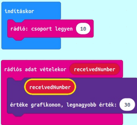
11.2. ábra: A hőmérsékletadatot fogadó program blokkábrája
