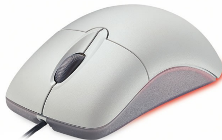
49. ábra: Egy egyszerű, kétgombos, görgős egér
