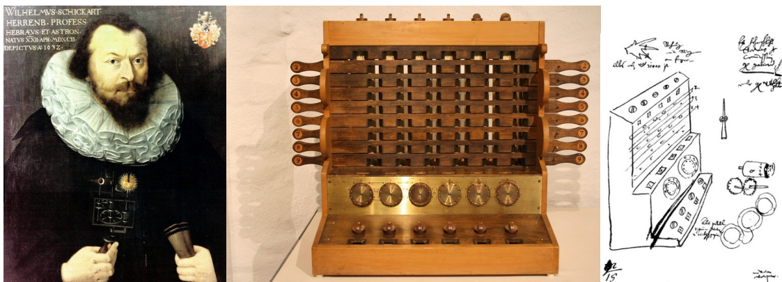
8. ábra: Wilhelm Schickard (baloldalt), az általa készített összeadó gép elvi ábrája (jobboldalt) és a gép egy modern kori rekonstrukciója (középen)
