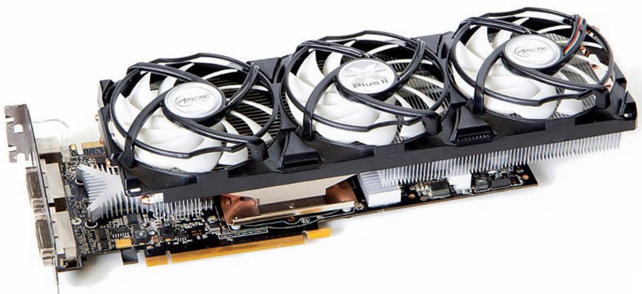
35. ábra: Három ventilátorral hűtött videokártya, amelynek célja a GPU maximális hatékonyságú hűtése (forrás: Wikipédia)
