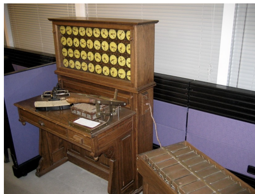
19. ábra: A Hollerith-féle lyukkártya rendező gép
