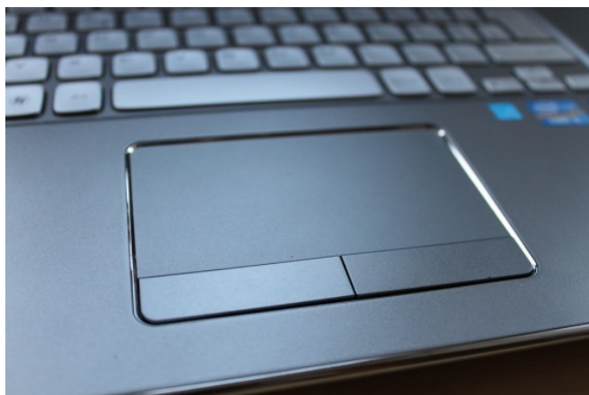
55. ábra: Touchpad, magyarul érintőpad, laptopok tipikus mutatóeszköze
