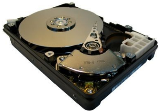
43. ábra: Egy modern merevlemez belseje. A sajátodat ne akard megnézni, hogy ilyen-e, mert ahhoz tönkre kell tenni!
